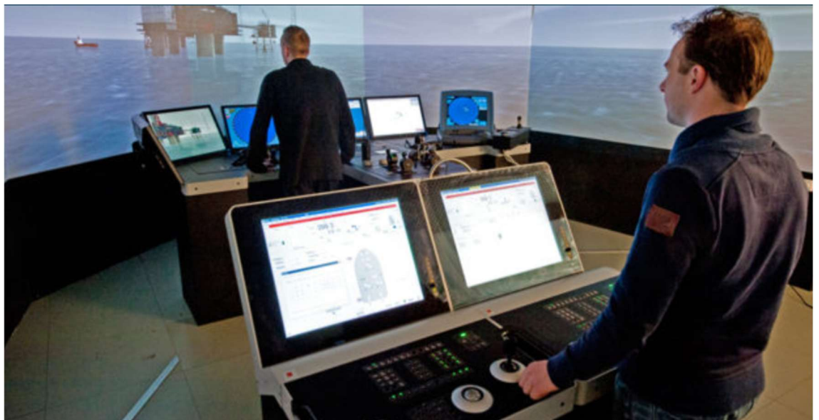
Figura 2 - Simulador de Posicionamento Dinâmico
